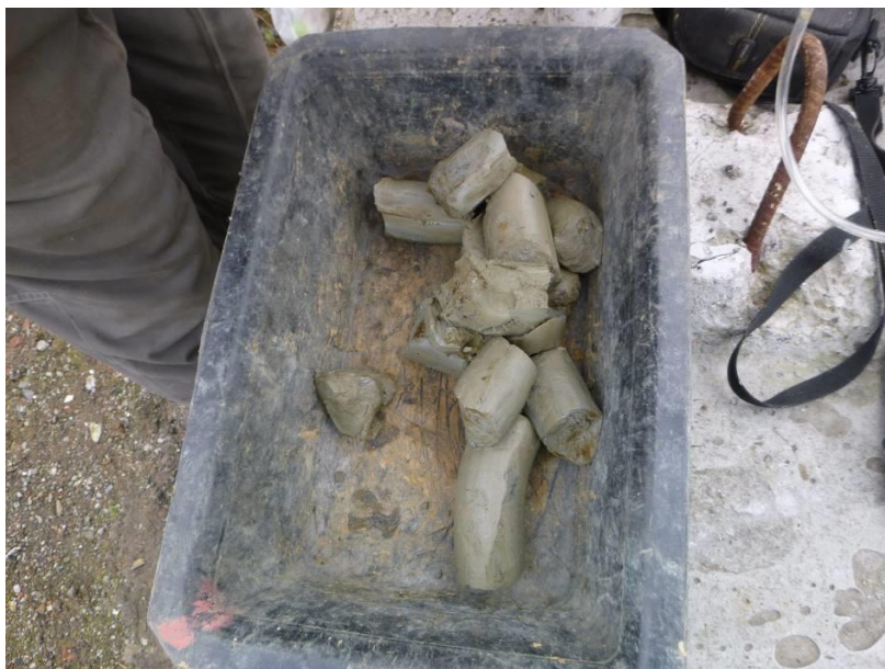
Illustration 4 - Matériaux gris/vert observés au droit du sondage S6 (Source : EACM, 04/2018)
